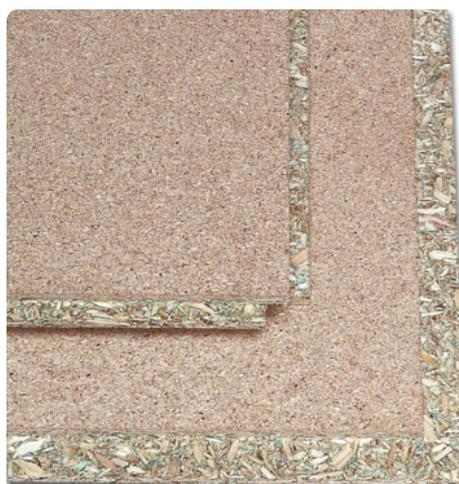
Homogen E1E05 Modul P3 Verlegeplatte mit CE - Kennzeichnung. Eine Verlegeplatte mit Nut und Feder, für nichttragende Zwecke, zur Verwendung im Feuchtbereich, nur für die Verlegeart "schwimmend". Zur Erkennung Mittelschicht grün eingefärbt.
