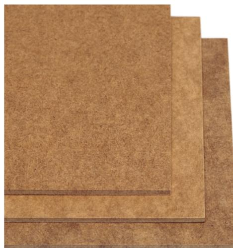
FunderMax Biofaser Standard ist ein Produkt für den universellen Einsatz im Innenbereich ohne besondere Anforderungen an die Festigkeit. Nach der Norm EN 622-2 entspricht die Platte dem Typ HB. FunderMax Biofaser ist eine auf der Oberseite ungeschliffene und unbehandelte Faserplatte.
