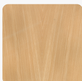
Buche gedämpft furniert Oberflächenstruktur Furnier
