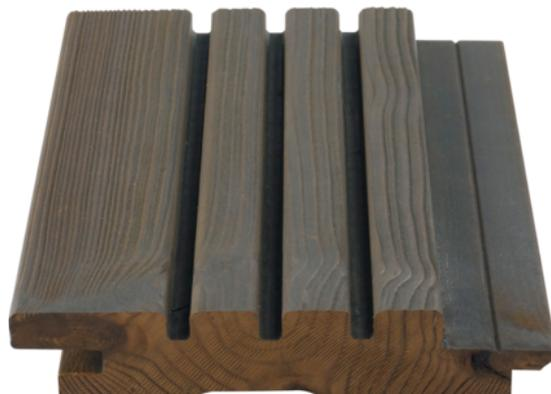
Was aufwendig scheint, ist doch ganz einfach: Die Profile aus Thermo-Kiefer lassen sich durch eine Nut-Feder-Verbindung leicht verbinden. Durch die Profilierung sind die Schraubbefestigungspunkte gut geschützt und Regenwasser wird perfekt abgeleitet.
