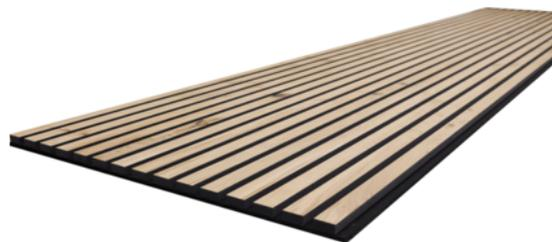
Die Akustik-Designpaneele bestehen aus einem Träger aus PET-Vlies mit echtholz furnierten MDF Lamellen. Die Oberfläche ist mit Hartwachs behandelt, wodurch das Holz optimal geschützt ist. Die Kanten sind leicht gefast. An der Rückseite der MDF Lamellen befindet sich ein Gegenzugpapier, das ein Verziehen der Lamellen verhindert.
