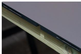
Fräsen Sie eigenständige Verbindungen mit Einschnitten von 10 mm für die beigefügten Verbindungsplättchen sowie die Kippbolzenschnitte auf der Rückseite ein. Verwenden Sie wenn möglich die Oberfräseschablone. Die Einschnitte für die Verbindungsplättchen sollten sich zwischen den Bolzenschnitten befinden und auf der gleichen Position der äußeren und inneren Schnittkanten gespiegelt sein. Sollte die Verbindung gekehrt sein, empfehlen wir die Verbindungsplättchen in die Gehrung einzufügen.
