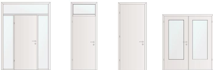
Windfang / optional mit Glas-Oberlichte und Seitenteil(en)    Türelement mit Glas-Oberlichte und Kämpfer    Türelement in Überhöhe    2-flügelig
