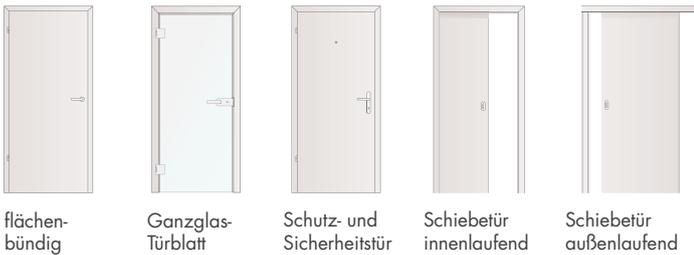
flächenbündig    Ganzglas-Türblatt    Schutz- und Sicherheitstür    Schiebetür innenlaufend    Schiebetür außenlaufend
