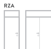
Raumhohe Zarge mit Querteil, Kämpfer und Oberlichte bis Stocklichhöhe von 2.520 mm (einflügelig, zweiflügelig)
