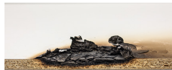
Querschnitt Eurodekor Flammex nach 30 Minuten Brenndauer
